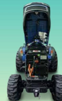
Motore a induzione 15 kW e batteria al litio
