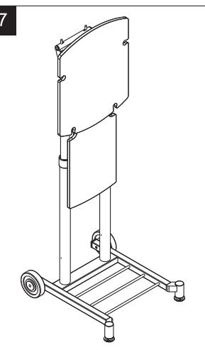
1. Rimuovere le viti che bloccano i cilindri del gas. Montare le ruote rivolte verso il retro del carrello. *Remove bolt that holds gas cylinder in position for transportation. Assemble wheel section. Wheels are facing back of unit.*
