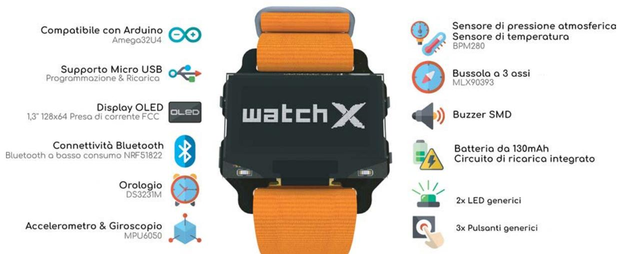
Il **kit WatchX** consiste in una scheda elettronica dotata di modulo **Bluetooth, accelerometro/giroscopio**, sensori di **pressione** e di **temperatura, orologio, LED, pulsanti, buzzer** e un sistema di ricarica. La confezione di WatchX include inoltre anche un **display OLED** da 1,3", una batteria da 130 mAh, il cavo microUSB per la ricarica del dispositivo e un **cinturino** universale modello NATO Strap.
