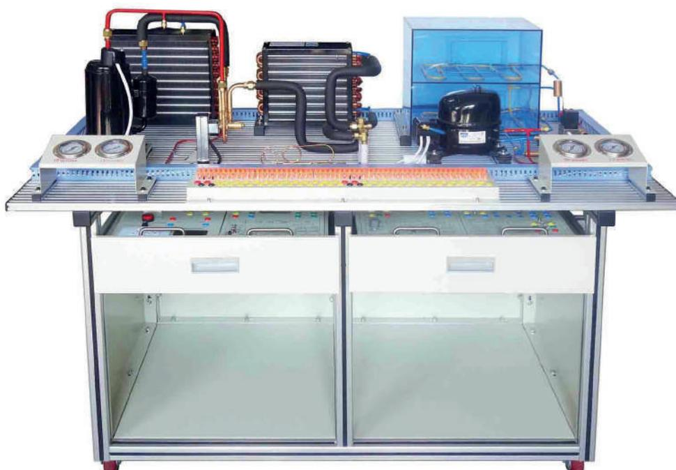
Il laboratorio didattico per lo studio di sistemi di refrigerazione e climatizzazione è progettato per fornire agli studenti o agli operatori la possibilità di acquisire competenze pratiche nella comprensione, nel funzionamento e nella manutenzione dei sistemi di refrigerazione e climatizzazione. Può essere utilizzato nei corsi di formazione e nelle scuole tecniche per offrire un'esperienza pratica e interattiva nell'apprendimento di questi sistemi.
