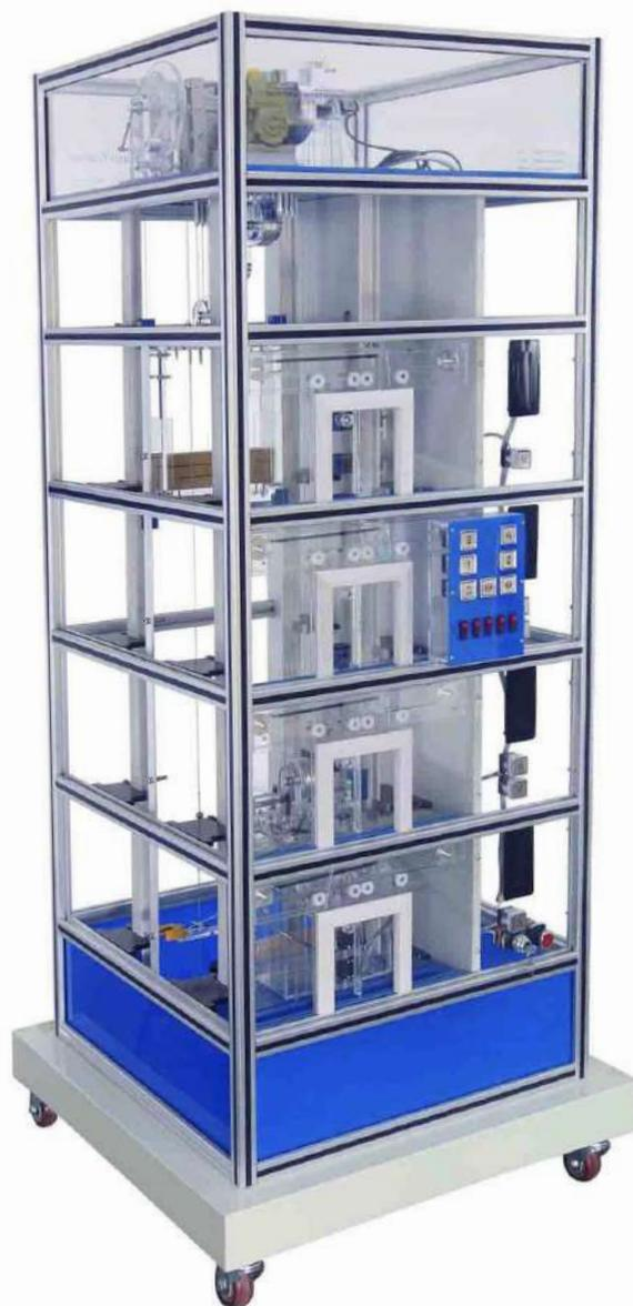
Il laboratorio per la formazione e l'apprendimento dell'automazione nei sistemi di controllo degli ascensori simula un sistema di ascensori a 4 piani con funzioni complete. Utilizza una struttura aperta completamente trasparente che rende visibili tutti i movimenti interni ideale per la dimostrazione e l'operazione di un sistema di ascensori completo in uno spazio limitato.
