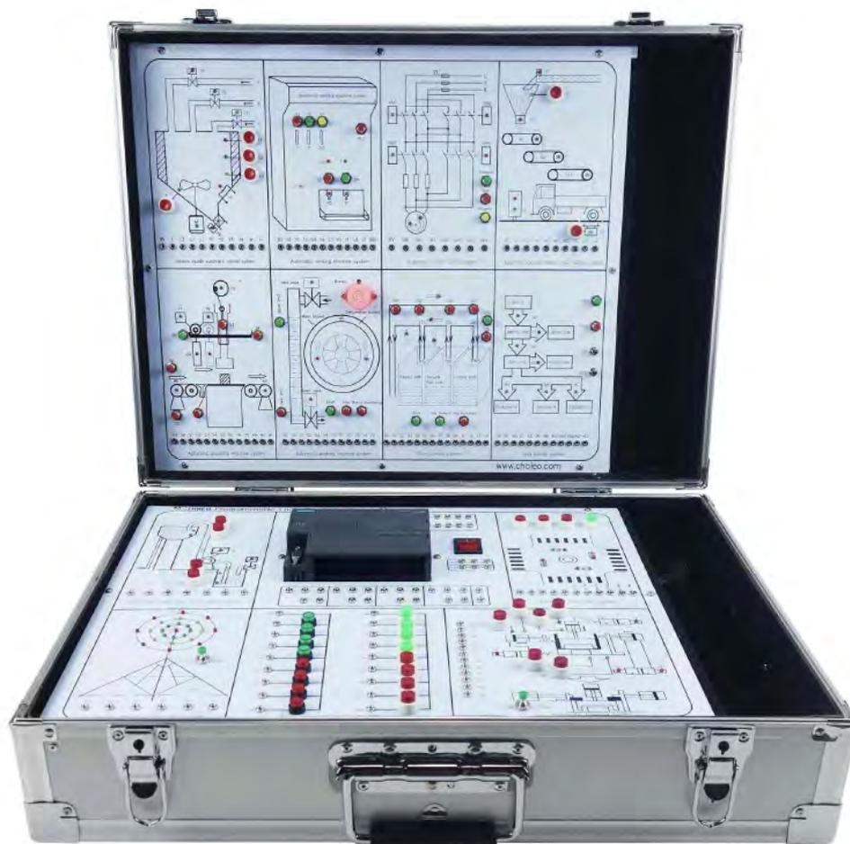
Il laboratorio di formazione PLC da tavolo è un sistema di formazione per PLC che simula le condizioni reali di utilizzo dei PLC.
