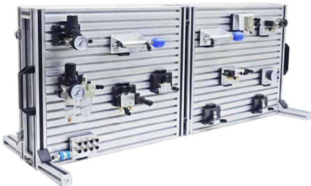
Il laboratorio portatile grazie alla struttura flessibile permette quattro diverse configurazioni per esperimenti di automazione pneumatica.
