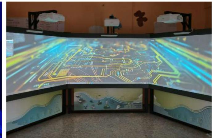
La superficie di proiezione è costituita da tre lavagne in acciaio che, a proiettori spenti, possono essere usate per la scrittura con pennarelli cancellabili a secco
